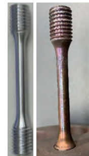
実験前後の試験片（実験後は焼けて変色）
