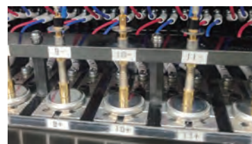
もみ殻由来シリコンを負極に用いたリチウムイオン電池の性能評価
