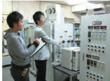
次世代冷媒の熱物性を世界最高精度で測定可能な計測システム
