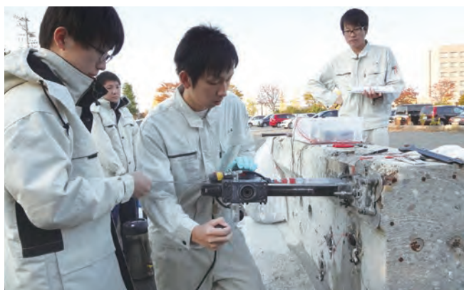
北陸道からの撤去橋桁を用いた点検技術の実証実験
