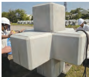
フライアッシュを用いた護岸ブロックの現場適用
