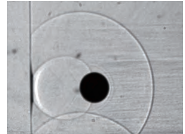
空中に浮遊した球と衝撃波との干渉（シャドウグラフ法による可視化画像）
