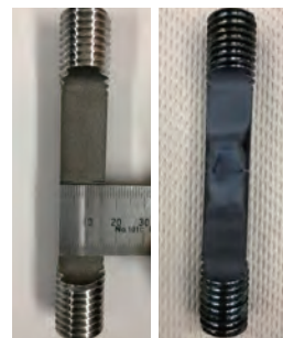
実験前後の両側き裂試験片（右は高温で変色）
