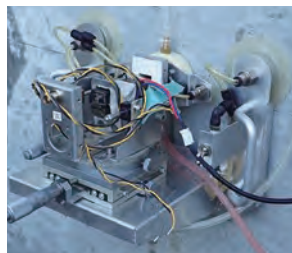
ウォーターカップリング磁歪センサによる内部欠陥探査
